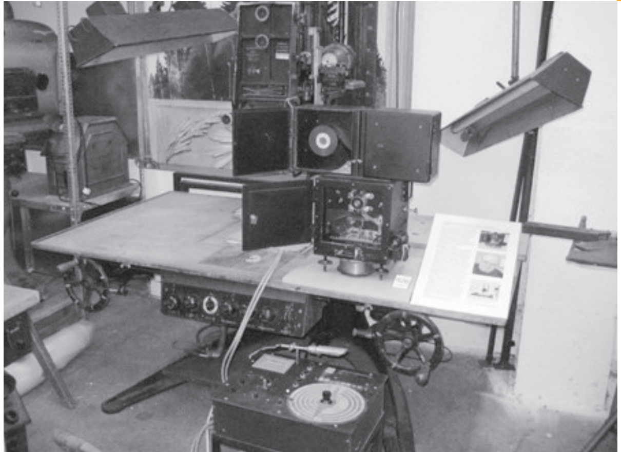
Marke Eigenbau. Die selbstgebaute 35mm-Trickfilmkamera von Bernd Blum
